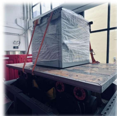
7、小型设备出货前进行振动测试
